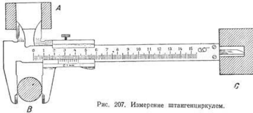
Рис. 207. Измерение штангенциркулем.
